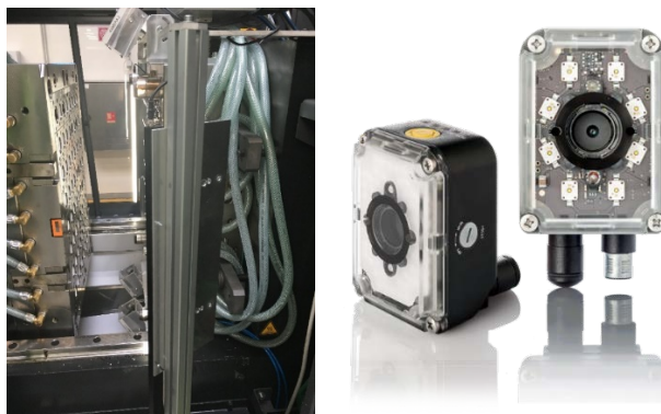
Slika 1: Levo slika prikazuje integracijo sistema MOLDEYE INSPECTOR, desno slika pa prikazuje pametne kamere DATALOGIC.
